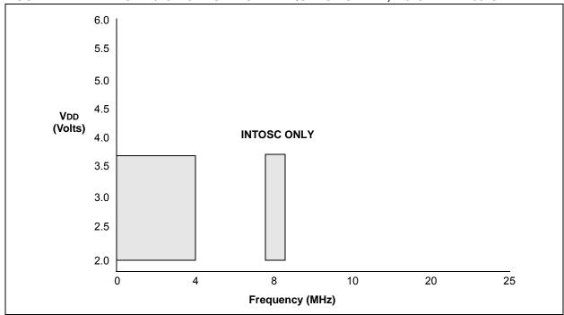
FIGURE 12-2: MAXIMUM OSCILLATOR FREQUENCY TABLE
