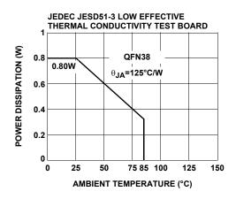
FIGURE 6. PACKAGE POWER DISSIPATION vs AMBIENT TEMPERATURE
