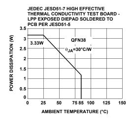
FIGURE 5. PACKAGE POWER DISSIPATION vs AMBIENT TEMPERATURE
