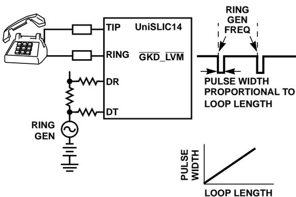
**FIGURE 6. OPERATION OF THE LINE VOLTAGE MEASUREMENT CIRCUIT**
