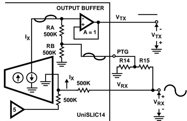
FIGURE 5. TRANSHYBRID BALANCE USING THE PTG PIN
