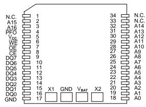
34-Pin PowerCap Module Board (Uses DS9034PCX+ or DS9034I-PCX+ PowerCap)
